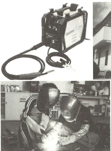
〈左上〉「SUZUKID」ブランドの代表作SIG140。溶接棒の長さを自動的に調節する「半自動」タイプのパイオニアとして注目を集めめた。〈右上〉「Fe☆NEEDS WELDERSPOINT 鎌倉店」外観。〈左下〉定期的に開催されている溶接ワークショップのひとコマ
