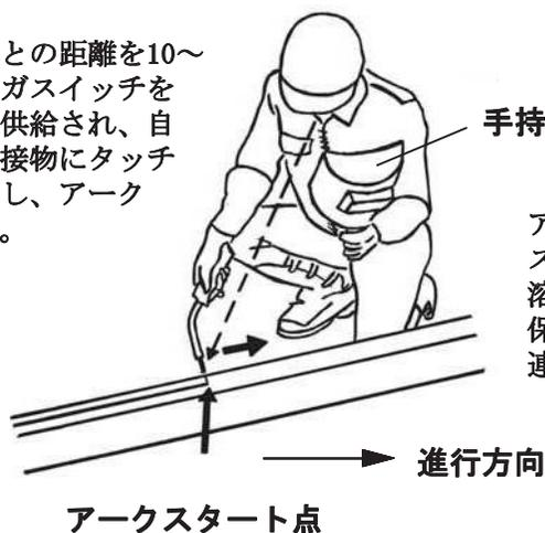
アークスタートしたら、トリガスイッチを押したままノズルと溶接物との距離を10～15mmに保ったままトーチを移動すれば連続した溶接となります。
