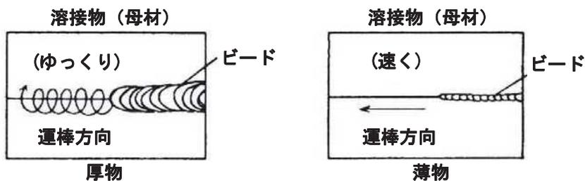
移動速度は溶接物(母材)に穴があかない程度で、できるだけゆっくりした方が溶け込みが深く理想的といえます。溶接途中にアークが途切れてしまった場合は、溶接部が溶けているうちにすばやく続きからアークスタートして溶接してください。溶接が冷え固まってしまった場合も続きを溶接してください。「溶けているうち」又は「冷え固まってから」いずれの場合にも前の溶接した部分が5~10mm程度重なる様にしてください。
