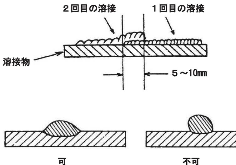
ビード(溶接されたミミズバレ状のもの)がなめらかにならず丸い球になってしまうのはトーチの移動が速すぎます。トーチの移動を遅くしても球になってしまうのは溶接物(母材)が厚すぎます。
