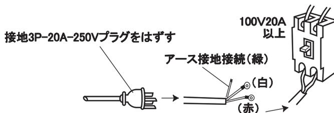
ハ. 200V電源へ接続する場合は、接地3P-20A・250Vのコンセントへ直接接続するか、又は接地3P-20A-250Vプラグをはずして直接ブレーカへ接続してください。
