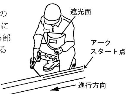
8. 溶接が終了したら、溶接棒を溶接物より引き離し、アークを切ってください。
