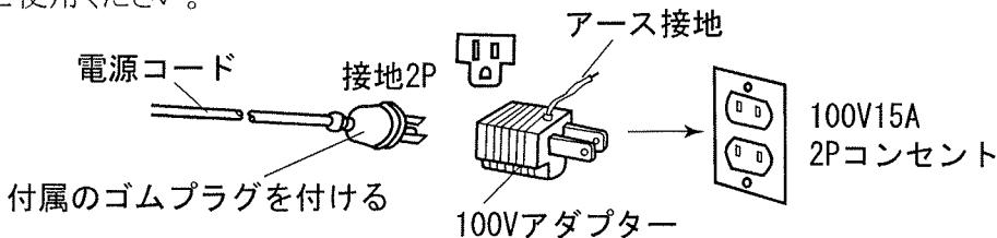
(100V15A接地2Pコンセントへ接続の場合は、付属のゴムプラグを取り付け後、100Vアダプターを使用せずに、ご使用いただけます。)
