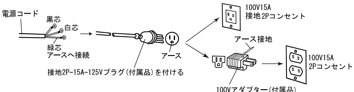
(100V15A 接地2Pコンセントへ接続の場合は、接地2P-15A-125Vプラグ(付属品)を取り付け後、100Vアダプター(付属品)を使用せずに、ご使用いただけます)
