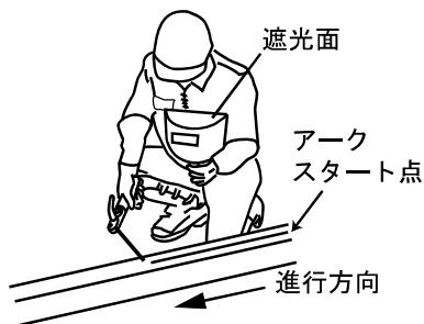
8. 溶接が終了したら、溶接棒を溶接物より引き離し、アークを切ってください。
