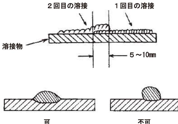
ビード(溶接されたミミズバレ状のもの)がなめらかにならず丸い球となってしまうのはトーチの移動が速すぎます。トーチの移動を遅くしても球になてしまうのは溶接物が厚すぎます。
