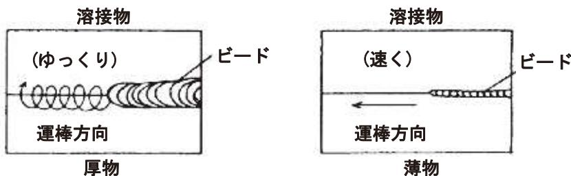
移動速度は溶接物に穴があかない程度で、できるだけゆっくりした方が溶け込みが深く理想的といえます。溶接途中にアークが途切れてしまった場合は、溶接部が溶けているうちにすばやく続きからアークスタートして溶接してください。溶接が冷え固まってしまった場合も続きを溶接してください。「溶けているうち」又は「冷え固まつてから」いずれの場合にも前の溶接した部分が5～10mm程度重なる様にしてください。
