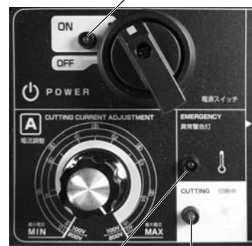
異常警告灯 切断中ランプ
