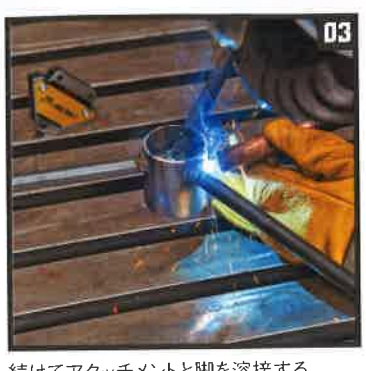
03 続けてアタッチメントと脚を溶接する
