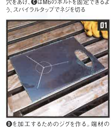
01 Dを加工するためのジグを作る。端材の鉄板に円を描き、3等分になるよう120度の位置に墨つける
