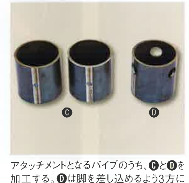
01 アタッチメントとなるパイプのうち、CとDを加工する。Dは脚を差し込めるよう3方に穴をあけ、CはM6のボルトを固定できるように、スパイラルタップでネジを切る
