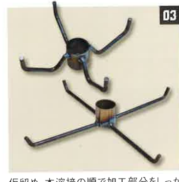
03 仮留め、本溶接の順で加工部分をしっかりと溶接する。ふたつのハンガーパーツができあがった
