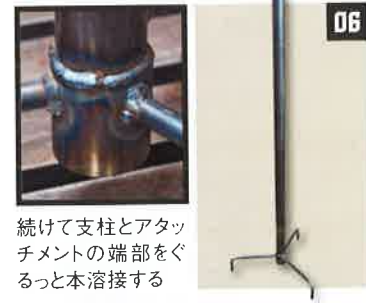
06 続けて支柱とアタッチメントの端部をぐると本溶接する
