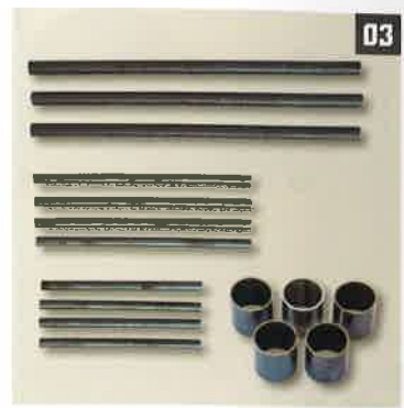
03 丸鋼、パイプのカットが完了した
