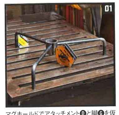
01 マグホールでアタッチメントDと脚Gを仮留めし、溶接する。脚が地面に垂直に立つよう設置角度に注意
