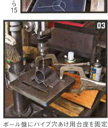
03 ボール盤にパイプ穴あけ用台座を固定し、5mm径のドリルビットで下穴をあける
