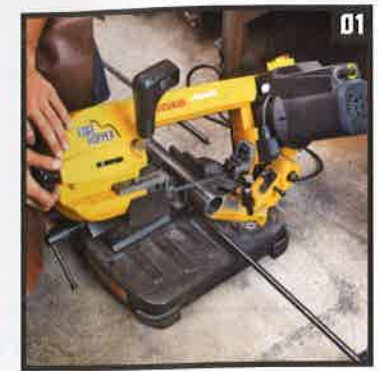
01 バンドソーを使って、各資材を加工表の長さにカットする
