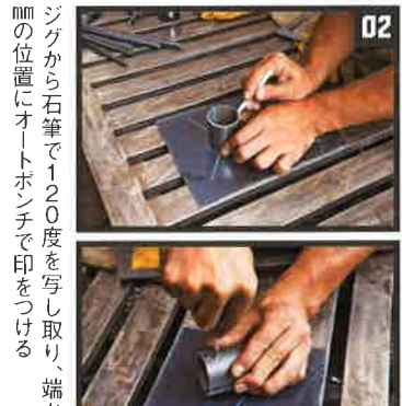
02 ジグから石筆で120度を写し取り、端から15mmの位置にオートポンチで印をつける
