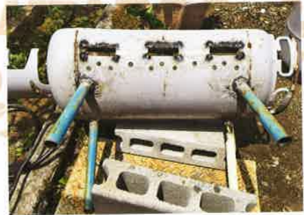
丸パイプの脚を溶接したところ。ガスボンベの開閉部は空気孔。プラズマ切断機で切り抜いた
