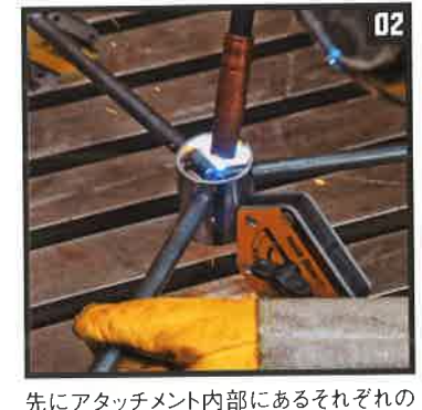
02 先にアタッチメント内部にあるそれぞれの脚先端を溶接する
