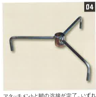
04 アタッチメントと脚の溶接が完了。いずれも仮留め、本溶接の順でしっかりと固定する
