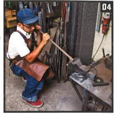
04 フックE、F、脚Gとなる丸鋼はテーブルバイスとハンドルで曲げ加工を施す
