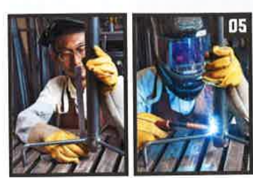
05 脚部に支柱Aを垂直に溶接する。はじめに前後左右4点を仮留めし、支柱が垂直に立つよう調整
