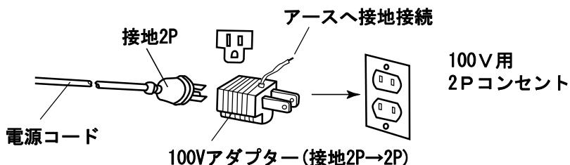
注) 100V接地2P(3P)コンセントからの使用の場合は、100Vアダプターを使用せず、そのままご使用いただけます。
