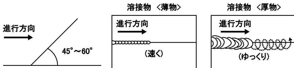
移動速度は溶接物に穴が開かない程度にできるだけゆっくりした方が溶け込みが深くなり理想的です。
