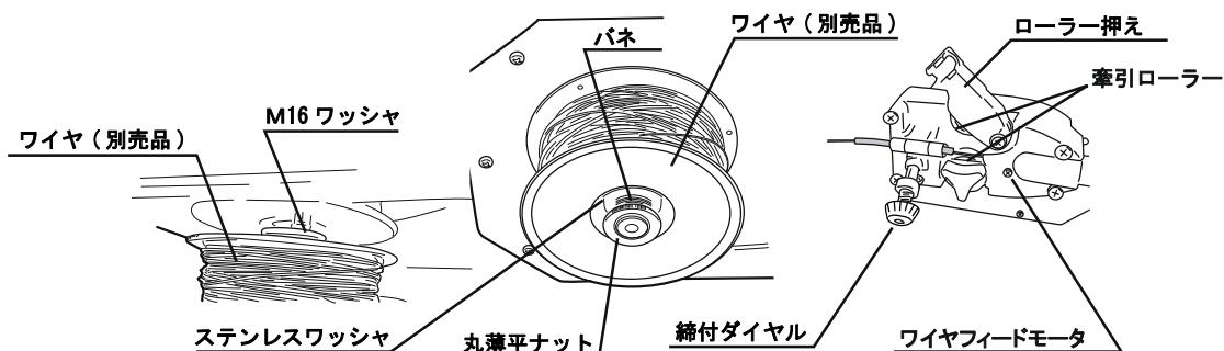
※ワイヤは丸薄平ナット、バネ、ステンレスワッシャを使用して取り付けます。(詳細はP.7を参照ください。)
