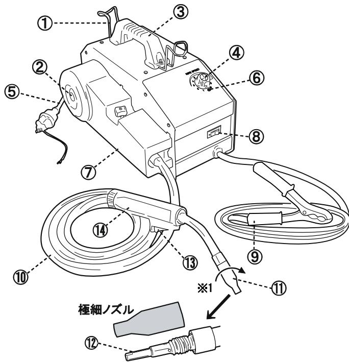
\*1 極細ノズルは、取り外す時も取り付ける時も右ネジ方向
