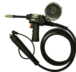
SSG-201 スプールガン (長さ 10m / Φ0.8mm 用チップ / Φ0.8mm ~ 0.9mm・Φ1.0mm 用ローラー) ※スプール径 Φ100 ワイヤ専用
