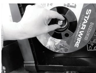
スピンドルカバーの凸部が  $\phi 200$  のスプールの凹部に入るように取り付けます。
