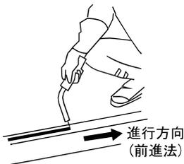
アークがスタートしたら、ノズルと溶接物との距離を10～15mmに保ったままトーチを移動すれば連続した溶接となります。
