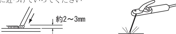
溶接物と溶接棒が溶着して離れない場合はホルダから溶接棒をはずすか又は電源を切ってください。そのままにしますと短絡電流が流れ続け、発火の原因や本機寿命の低下につながります。
