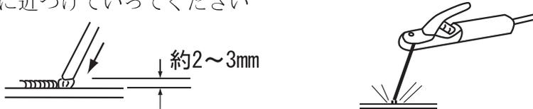
溶接物と溶接棒が溶着して離れない場合はホルダから溶接棒をはずすか又は電源を切ってください。そのままにしますと短絡電流が流れ続け、発火の原因や本機寿命の低下につながります。
