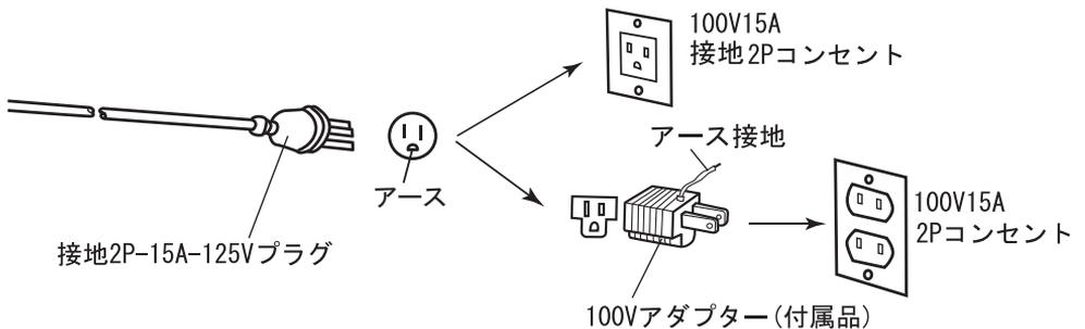
（100V15A 接地 2P コンセントへ接続の場合は、100V アダプター（付属品）を使用せずに、ご使用いただけます）
