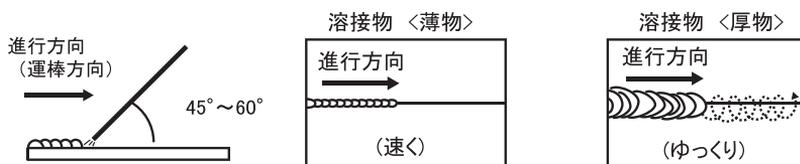
ビード(溶接金属によりできたミミズバレ状の跡)が滑らかにならず、丸い玉になってしまうのは溶接棒の移動が速いためです。溶接棒の移動を遅くしても玉になってしまうのは溶接物が厚すぎるためです。溶接機にあった適正な厚みで溶接してください。
