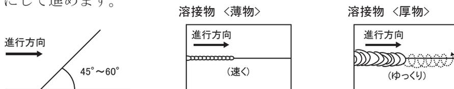
移動速度は溶接物に穴があかない程度にできるだけゆっくりした方が溶け込みが深くなり理想的です。溶接途中にアークが途切れてしまった場合は、前に溶接した部分が5~10mm重なるようにしてください。
