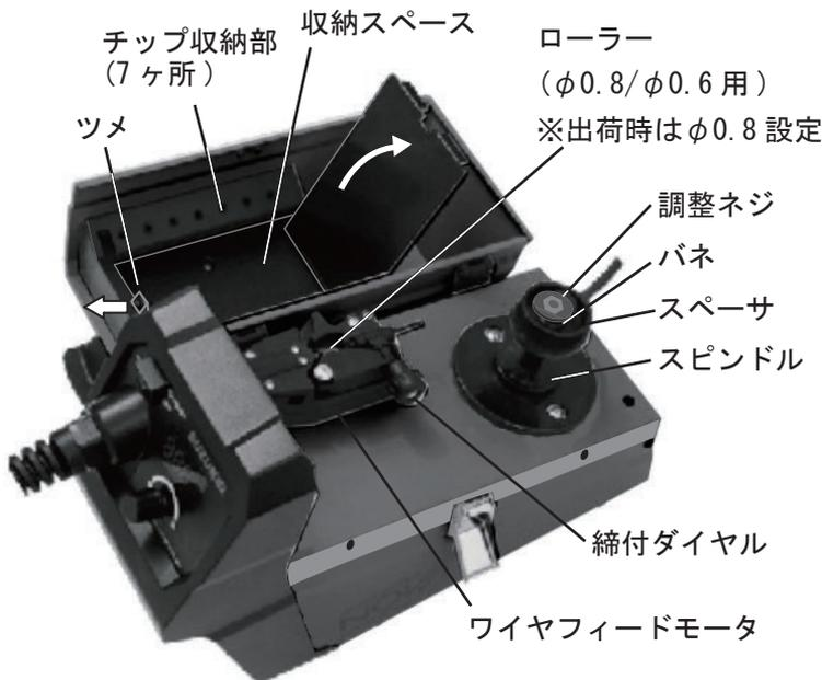
収納BOXのフタを開ける際、ツメに過度に力を加えるとツメが折れてしまいますので、軽く外側へ押して収納BOXのフタを引き上げるようにしてください。
