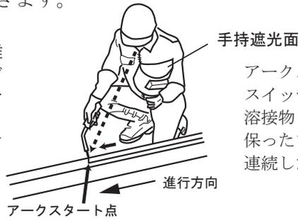
アークスタートしたら、トリガスイッチを押したままチップと溶接物との距離を、10~15mmに保ったままトーチを移動すれば連続した溶接となります。
