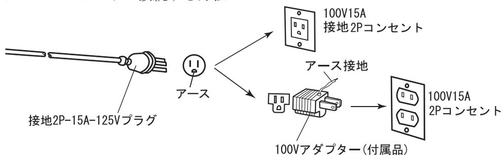
(100V15A 接地2Pコンセントへ接続の場合は、100Vアダプター(付属品)を使用せずに、ご使用いただけます)
