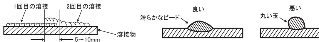
ビード(溶接金属によりできたミミズバレ状の跡)が滑らかにならず丸い玉になってしまうのはトーチの移動が速いためです。トーチの移動を遅くしても玉になってしまうのは溶接物が厚するためです。溶接機にあった適正な厚みで溶接してください。
