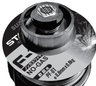
※調整ネジはスピンドルのネジ部先端と調整ネジ上端が同じ高さの位置になる様に固定してください(上図 斜線部)
