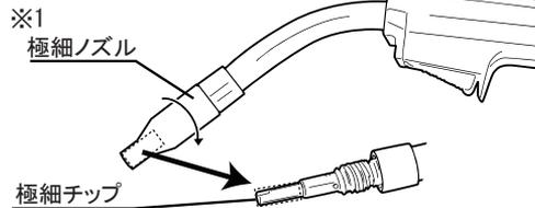
※1. ※2. ノズルは、取り外す時も取り付ける時も右ネジ方向(時計方向)へ回しながら行ってください。
