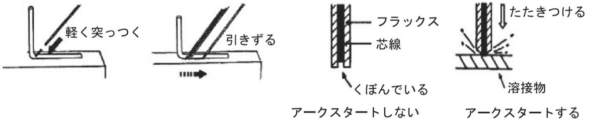
溶接物をひっかいた後、溶接物と溶接棒の間隔を2～3mm程度とるようにするとアークが持続します。溶接物と溶接棒が溶着した場合はホルダを左右に振りすばやく引き離してください。溶接棒が溶けてだんだん短くなるとともにホルダを溶接物に近づけていってください
