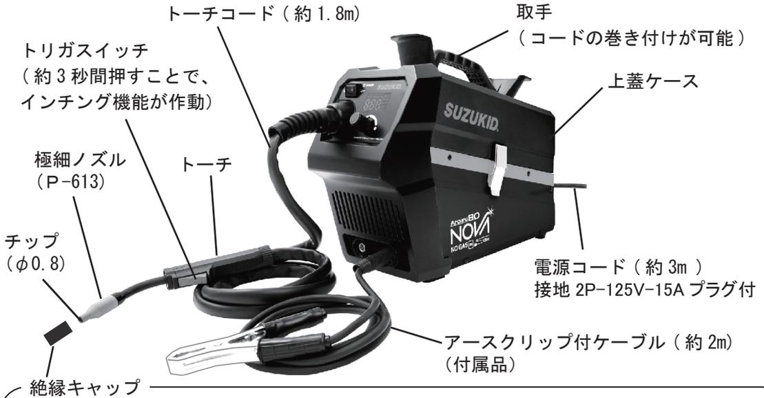
MMA モード時の通電から保護する為、MMA 使用時には必ず取り付けてください。電源が OFF、ノズルが冷めている状態の時に取り付け、取り外し作業を行なってください。取り付けや取り外しの際は極細ノズルの付け根を持って、まっすぐに絶縁キャップを押し込む、または引き抜きます。(使いはじめは極細ノズルとの嵌合がキツイ場合があります。使用しているうちに取付け易くなります。)
