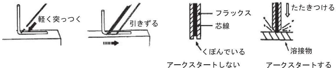
溶接物をひっかいた後、溶接物と溶接棒の間隔を2~3mm程度とするようにするとアークが持続します。溶接物と溶接棒が溶着した場合はホルダを左右に振りすればやくひき離してください。溶接棒が溶けてだんだん短くなるとともにホルダを溶接物に近づけていってください
