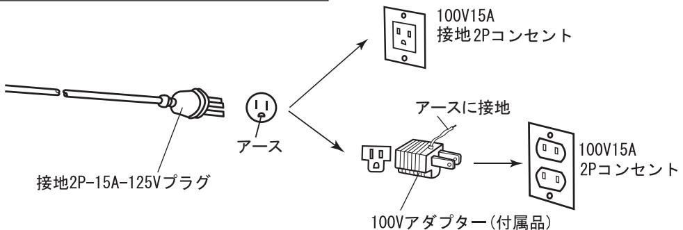
(100V15A 接地2Pコンセントへ接続の場合は、100Vアダプター(付属品)を使用せずに、ご使用いただけます)
