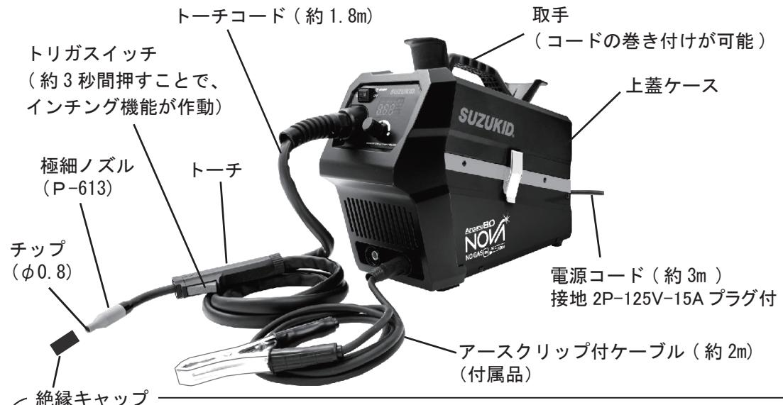
MMA モード時の通電から保護する為、MMA 使用時には必ず取り付けてください。電源が OFF、ノズルが冷めている状態の時に取り付け、取り外し作業を行なってください。取付けや取り外しの際は極細ノズルの付け根を持って、まっすぐに絶縁キャップを押し込む、または引き抜きます。(使いはじめは極細ノズルとの嵌合がキツイ場合があります。使用しているうちに取付け易くなります。)
