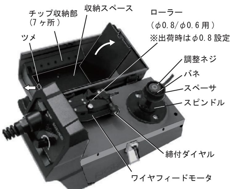
収納BOXのフタを開ける際、ツメに過度に力を加えるとツメが折れてしましますので、軽く外側へ押して収納BOXのフタを引き上げるようにしてください。
