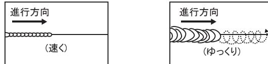
移動速度は溶接物に穴があかない程度にできるだけゆっくりした方が溶け込みが深くなり理想的です。溶接途中にアークが途切れてしまった場合は、前に溶接した部分が5~10mm重なるようにしてください。
