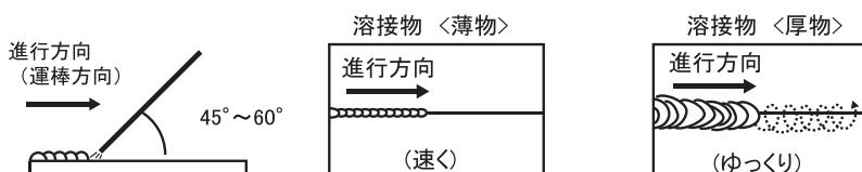
ビード（溶接金属によりできたミミズバレ状の跡）が滑らかにならず、丸い玉となってしまうのは溶接棒の移動が速いためです。溶接棒の移動を遅くしても玉となってしまうのは溶接物が厚すぎるためです。溶接機にあった適正な厚みで溶接してください。
