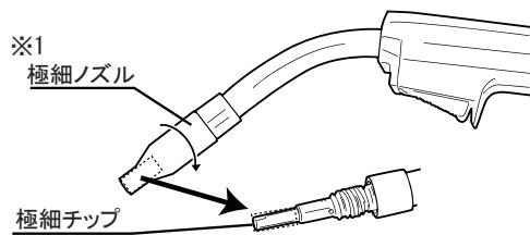
※1. ※2. ノズルは、取り外す時も取り付ける時も右ネジ方向（時計方向）へ回しながら行ってください。
