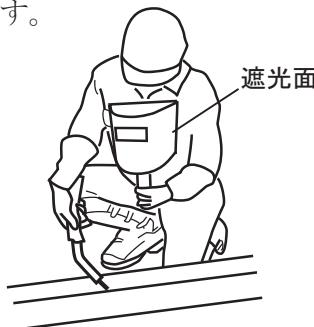
アークスタートしたら、トリガスイッチを押したままチップと溶接物との距離を、10~15mmに保ったままトーチを移動すれば連続した溶接となります。
