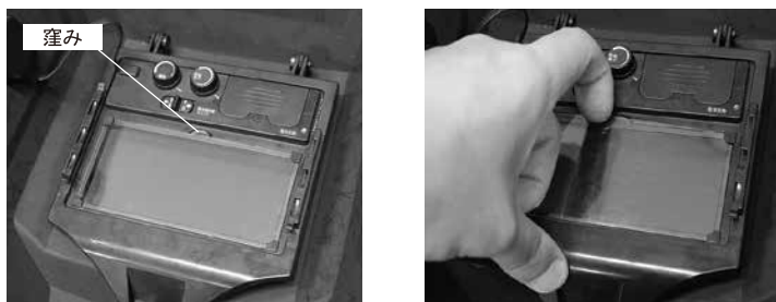
図6. 内側カバープレートの交換方法
