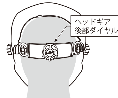
図2. 締め付けの調整
