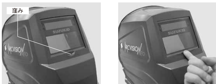
図5. 外側カバープレートの交換方法
