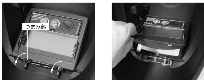
図5. 外側カバープレートの交換方法
