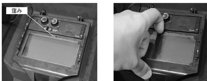
図6. 内側カバープレートの交換方法
