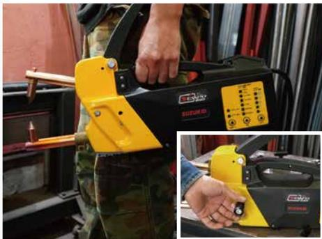
質量約9.6kgで軽量。付属品の取手を使用し本体を持ち上げて溶接可能。
