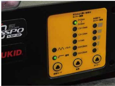
求める溶接の仕上がりに応じて、板厚と溶接時間の調整が可能。パルススポット機能搭載で、溶接物への熱影響を抑制。
