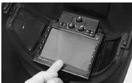
図2. 内側カバープレートの交換
