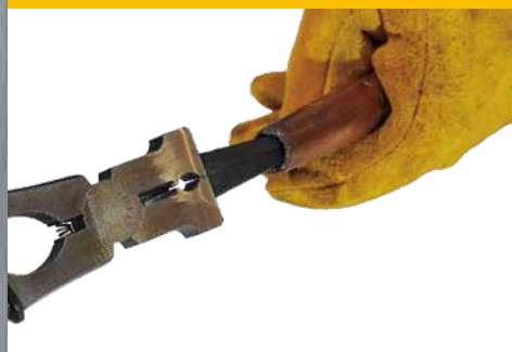
ノズル先端の スパッタ除去
