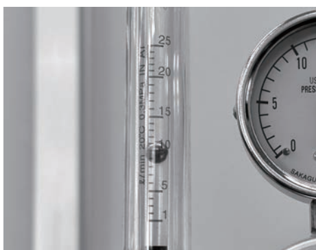
ガスの流量は、10l/min～15l/min
