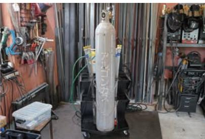
7立米ガスボンベを積載可能です。ガスボンベ固定チェーンが設置されているので、安全に積載できます。
